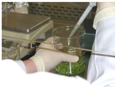
写真11：野菜（レタス）を生理食塩水に浸し残菌を抽出している様子
