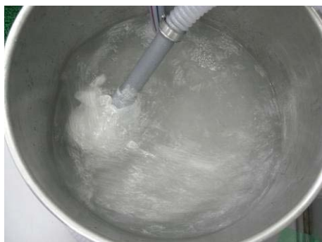
写真6：マイクロバブルオゾンが発生している様子
