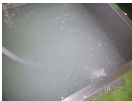
写真 2：発生しているマイクロバブルオゾン
