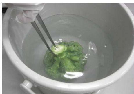
写真7：野菜（ブロッコリー）をマイクロバブルオゾンで洗浄している様子
